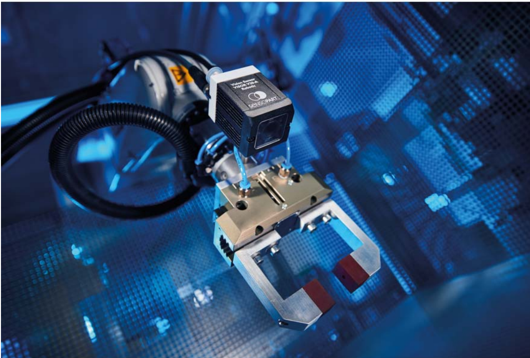
Image 1: Le VISOR® Robotic fournit au robot toutes les coordonnées dans son repère. Dans le logiciel de configuration, on peut configurer des applications robotiques en 2 D de manière simple et intuitive.
