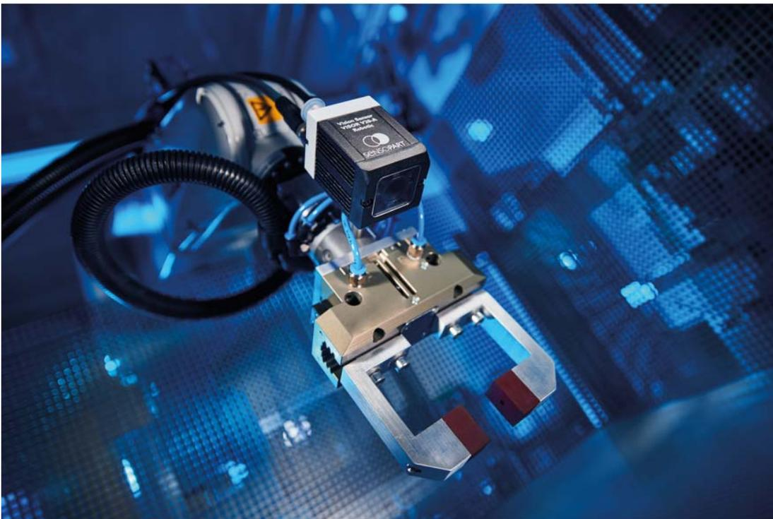
*Abb. 1: Der VISOR® Robotic liefert dem Roboter sämtliche Bilddaten in Roboterkoordinaten. In der Konfigurationssoftware lassen sich übliche 2D-Robotik-Anwendungen sehr einfach und komfortabel einrichten.*
