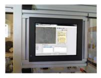
Pour utiliser le SensoWeb, il suffit d'entrer l'adresse IP du capteur à surveiller dans le navigateur. L'affichage plein écran de l'image en temps réel se fait soit en sélectionnant la fonction « zoom » sur l'interface, soit via un lien spécifique à saisir dans la barre de navigation. Si le Web monitoring n'est pas utilisé, on peut également désactiver la fonction.
